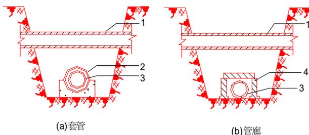
图 3.4.4 套管和管廊
