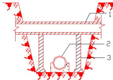
图 3.4.2 圆形管道两侧砖墩支承
